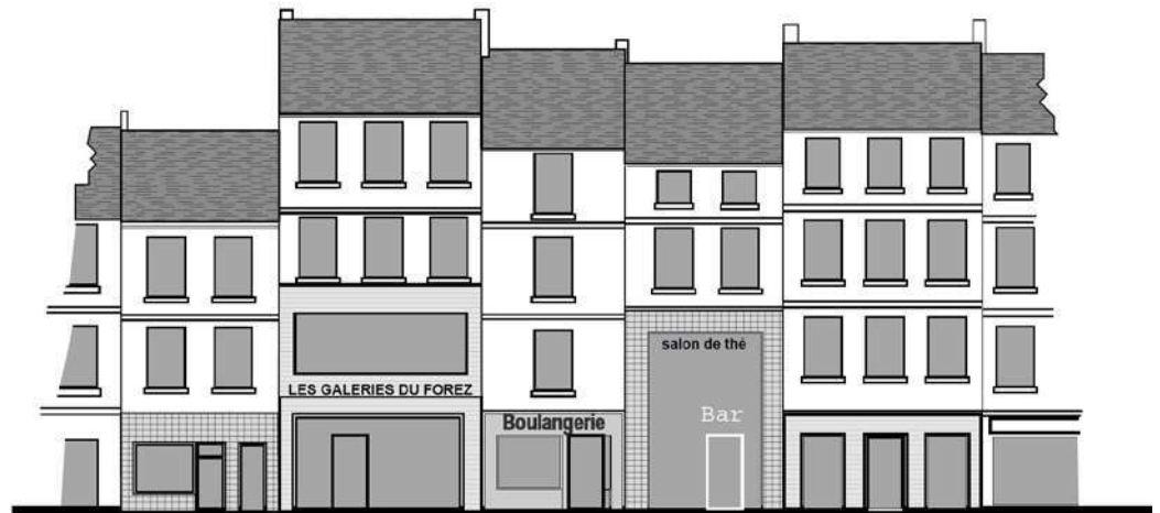
Des hauteurs de devantures trop diversifiées dans une rue perturbent l'homogénéité de l'alignement urbain
